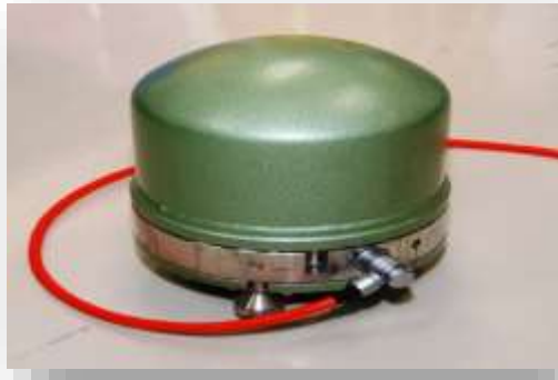
Üç- komponentli genişzolaqlı seysmometr, STS-2.5 və STS-2
